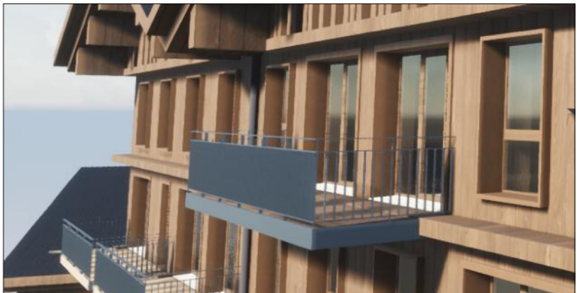
Garde-corps barreaudage métal + habillage nez de dalle tôle métal
